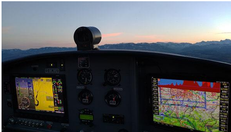
DYNON SKYVIEW mit Tablet PC mit Navigationssoftware und Warnsystemen
